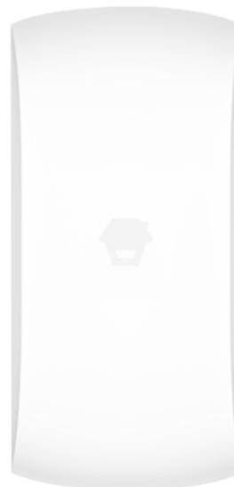
Contatto rivelatore magnetico che può essere utilizzato su porte, finestre e in generale qualsiasi oggetto che apre e chiude. Il sensore trasmette un avviso al pannello che farà scattare l'allarme quando si verifica uno spostamento del magnete. Invia anche un segnale d'allarme alla centrale in caso di batteria scarica.
